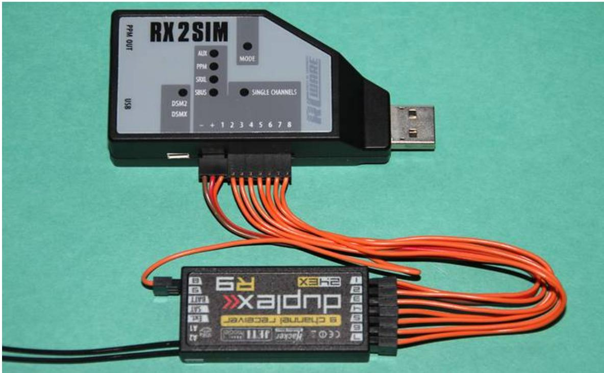
*Mit dem Patchkabel kann jeder Standardempfänger (GHz und MHz) an den RX2SIM angeschlossen werden.*
