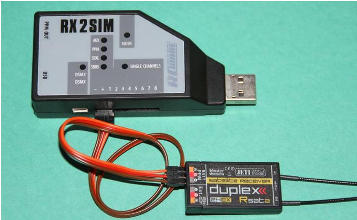
*Das PPM-Summsignal kann der RX2SIM ebenso verarbeiten wie SRXL, S.Bus, S.Bus2 und DSM2 bzw. DSMX.*
